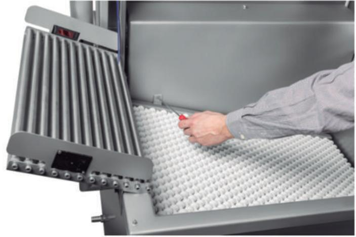
Bandeja interior desmontable fácil para acceso a limpieza/mantenimiento
